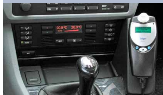
Dräger Interlock XT monterad vid förarplatsen
